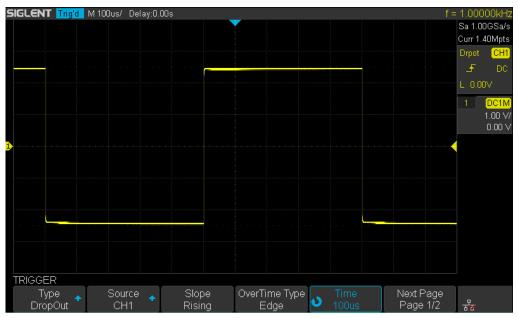
Figure 37 Edge Dropout Trigger
